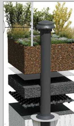
Mit zunehmender Aufbauhöhe der Schichten in intensiv begrüntem Flachdachern wächst auch die Notwendigkeit, das Flachdachzubehör entsprechend anzupassen. Ab Schichtaufbauten von mehr als 50 cm bieten die FLECK Gründachlüfter CLASSIC und MAX genau die richtige Lösung.
